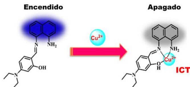
Figura 2. Funcionamiento de un sensor fluorescente selectivo a \text{Cu}^{2+} (Guo y col., 2019)
