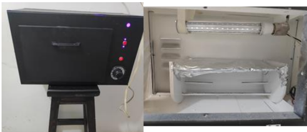
Figura 3. Caja adaptada con una lámpara UV LED
