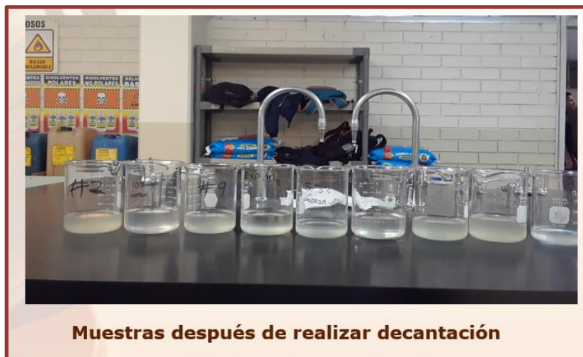
Imagen 2. Experimentos con una velocidad de agitación de 20 rpm. Fuente: Elaboración propia.
